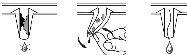
Um einen möglichen Bruch der Kopfbrause zu vermeiden, wird empfohlen, die Düsen regelmäßig wie abgebildet zu reinigen.
